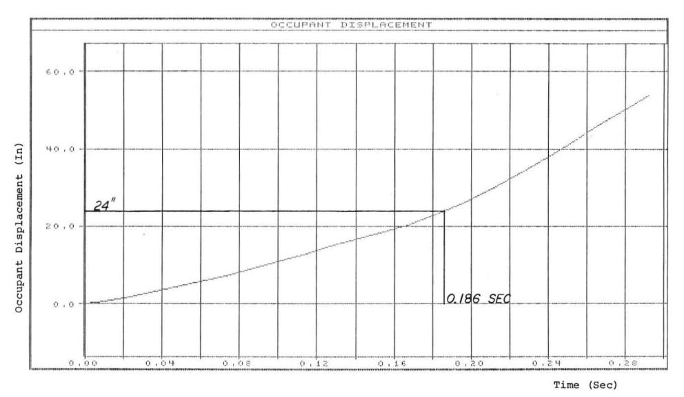
FIGURE C-9. GRAPH OF LONGITUDINAL OCCUPANT DISPLACEMENT, TEST 12-2
