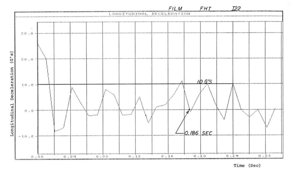
FIGURE C-7. GRAPH OF LONGITUDINAL DECELERATION, TEST 12-2
