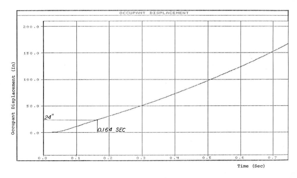
FIGURE C-3. GRAPH OF LONGITUDINAL OCCUPANT DISPLACEMENT, TEST 12-1
