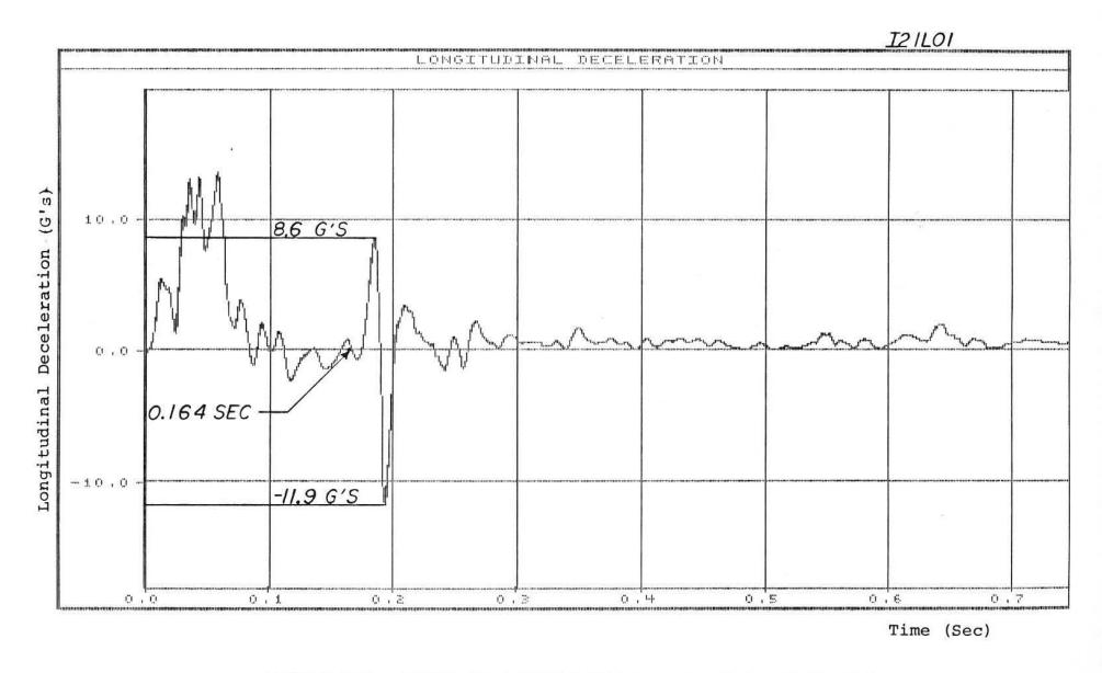
FIGURE C-1. GRAPH OF LONGITUDINAL DECELERATION, TEST 12-1
