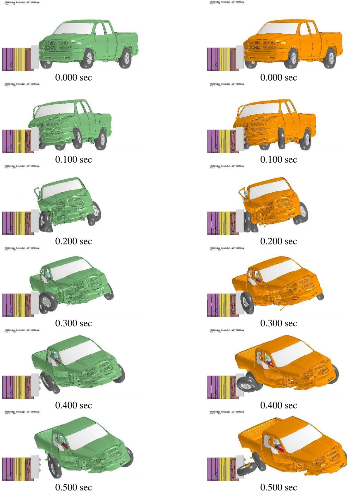
Figure D-7. 12.5:1 DS2 Simulation (Left) vs. 12.5:1 DS1 Simulation (Right) Sequential Images
