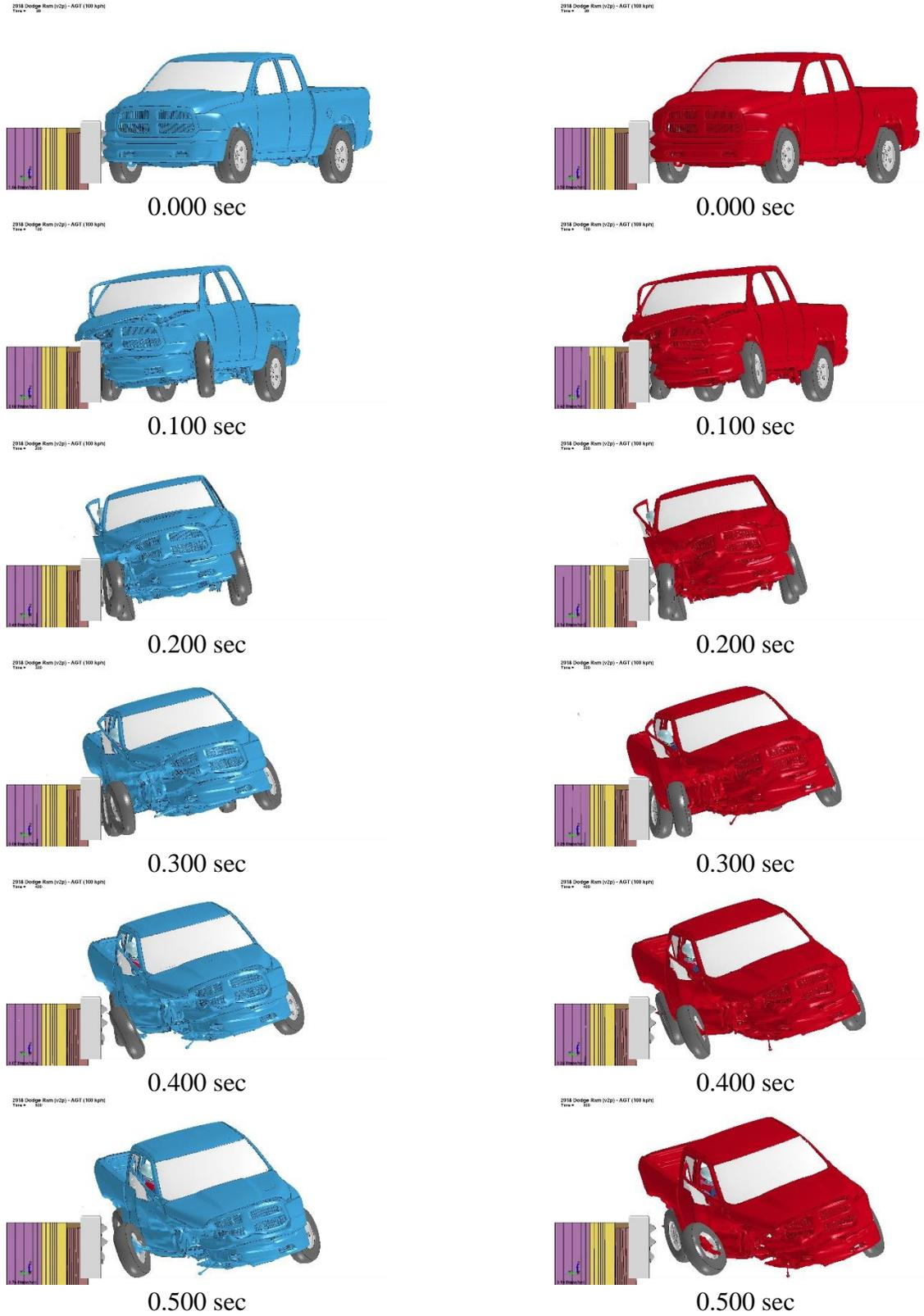
Figure D-1. 15:1 DS4 Simulation (Left) vs. 15:1 DS3 Simulation (Right) Sequential Images
