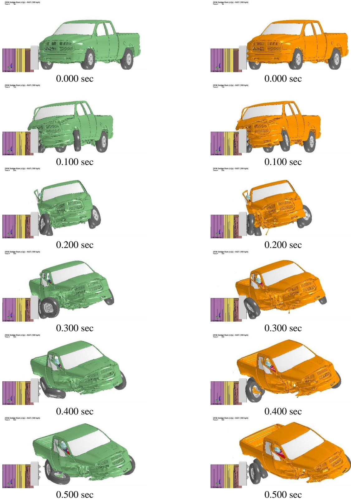
Figure D-2. 15:1 DS2 Simulation (Left) vs. 15:1 DS1 Simulation (Right) Sequential Images
