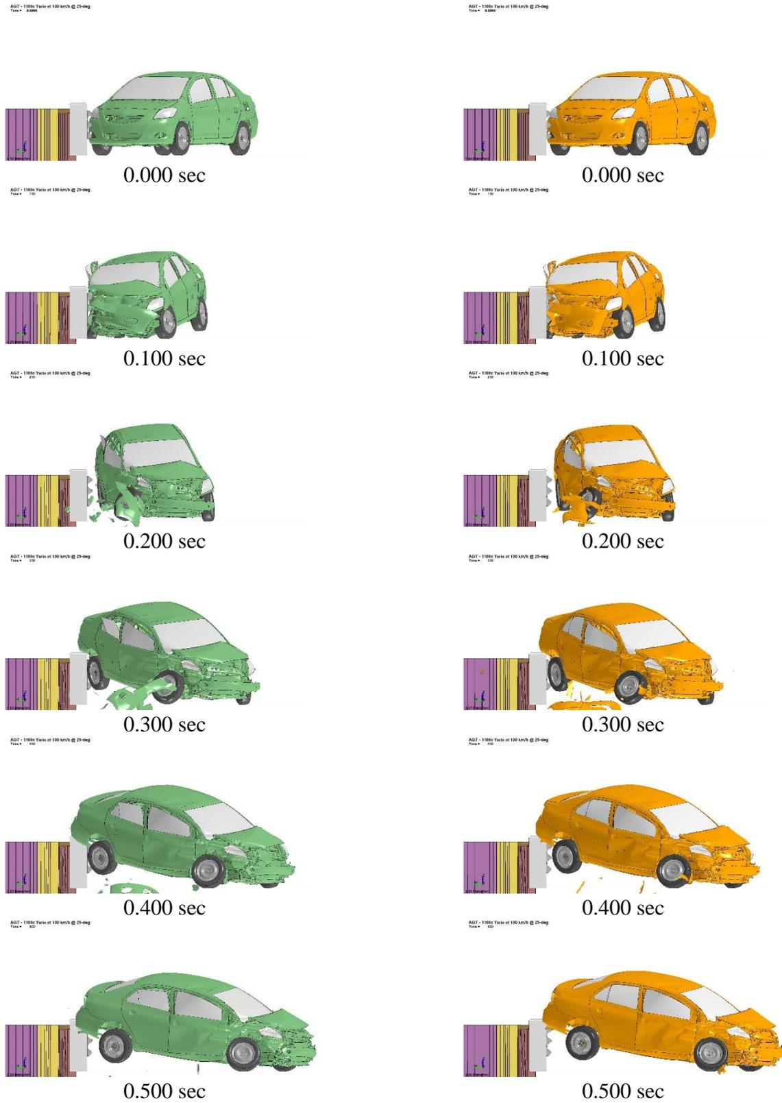
Figure E-2. 15:1 DS1 Simulation (Left) vs. 15:1 X Simulation (Right) Sequential Images
