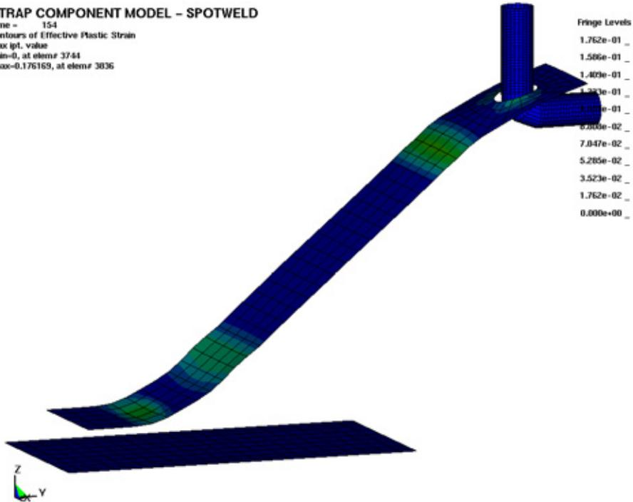
Figure 9. Strap Tie-Down Simulation
