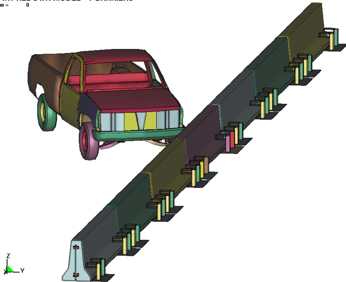
**Figure 9. Seven Barrier Tie-Down Model**
