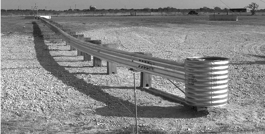
**Figure 25. Eccentric Loader Terminal.**
